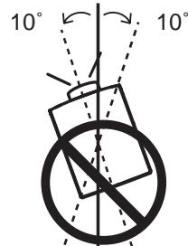
プロジェクターの水平軸を 10 度以上傾けて上方向に投映しないでください。
