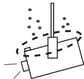
天井から吊り下げたり、高いところへ設置してご使用になるときは、吸気口や排気口、エアフィルターの掃除を定期的に行ってください。吸気口や排気口にホコリがたまると、冷却効果が悪くなり、内部の温度上昇を招いて故障や火災の原因となります。吸気口や排気口についてのホコリは掃除機などで取りのぞいてください。
