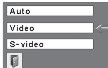
\* SCART 21 ピン端子は、主にヨーロッパ地域で販売されているビデオ機器に備えられているビデオ出力端子で、この端子の RGB 出力をプロジェクターで見るには、ビデオ機器の SCART 21 ピン端子とプロジェクターの [INPUT 1 ANALOG IN] を専用のケーブルで接続します。[INPUT 1 ANALOG IN] で再生される RGB SCART 信号は、480i、575i の RGB 信号のみです。コンポジットビデオ信号は再生されません。
