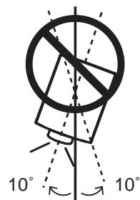
プロジェクターの水平軸を 10 度以上傾けて下方向に投映しないでください。
