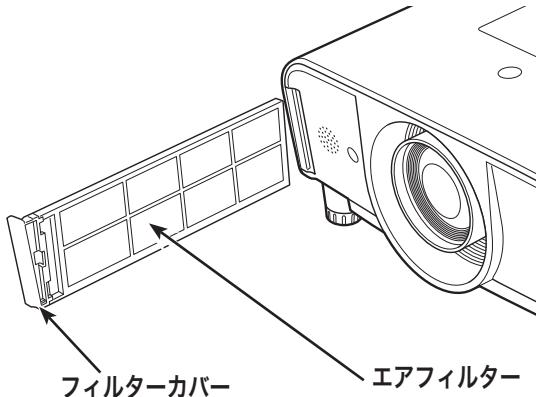
エアフィルターとフィルターカバーを分けるときは、フィルターカバー中央のへこみを指で押さながら引き離します。
