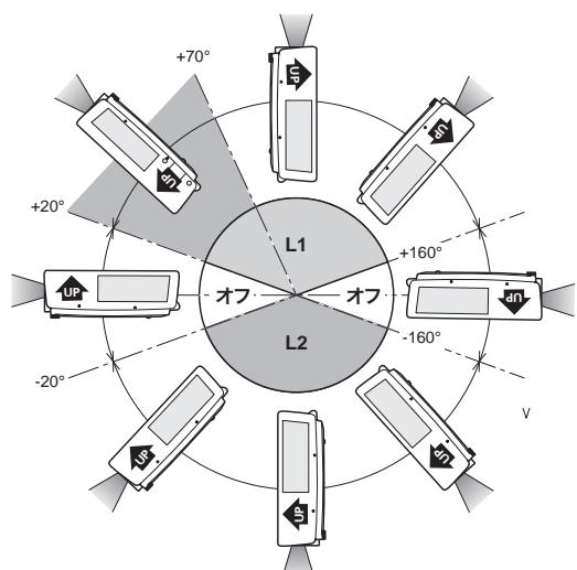
※ 上図のように、プロジェクターを斜め上向きに設置する場合は、裏返し設置してください。
