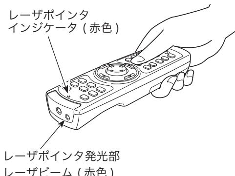
リモコンの [LASER] ボタンを押している間 [レーザポインタ] インジケーター（赤色）が点灯し、リモコンのレーザポインタ発光部からレーザビームが出ます。 [図] 18~19 ページ
