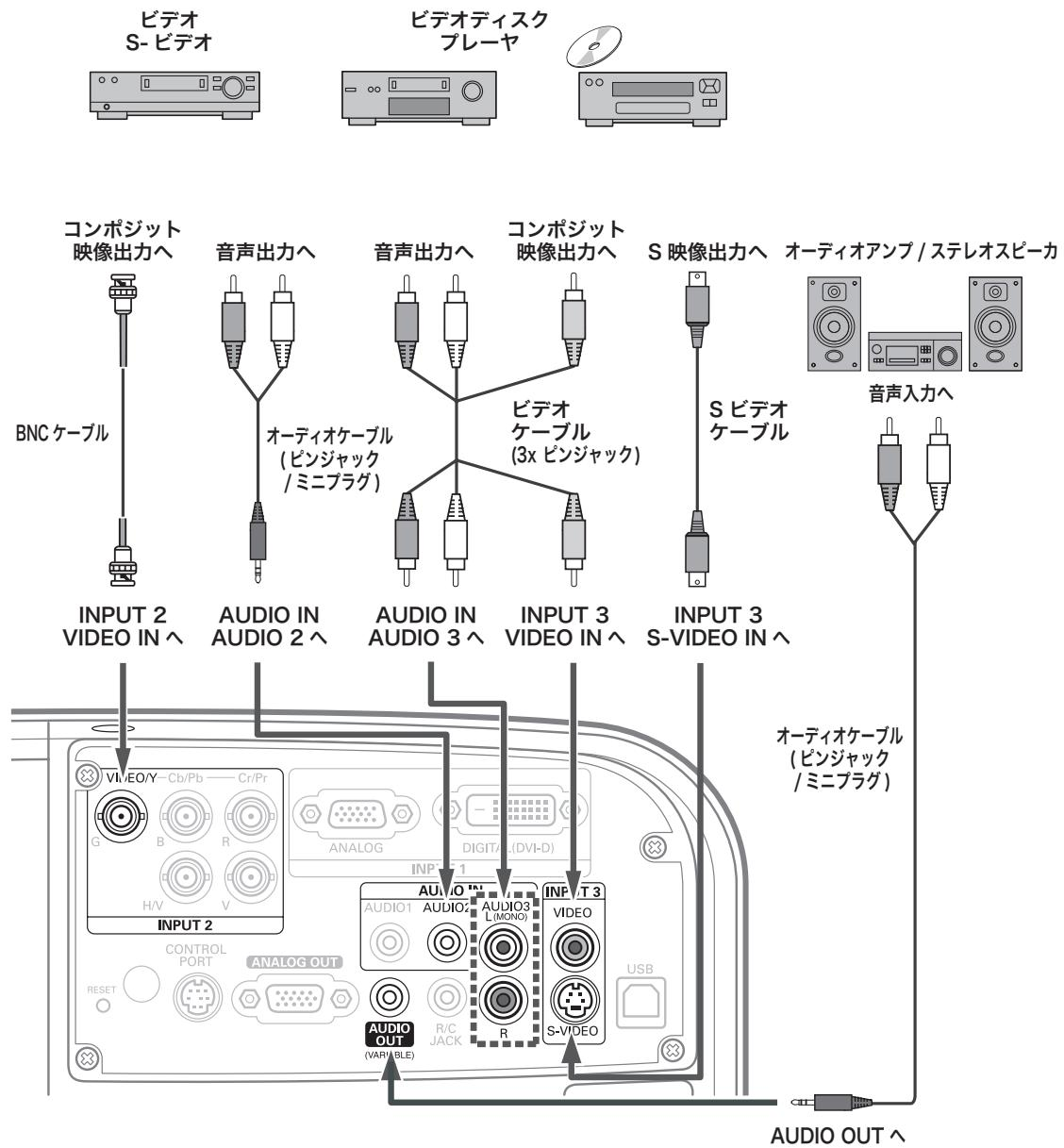
※2台のビデオ機器を接続しているときは、インプットメニュー内の信号選択メニューで「Auto」に設定していても、プロジェクターは入力端子へのプラグの挿入（信号の有無ではない）を検知して、1) S-video、2) Video の順位で入力端子を自動選択します。接続されている入力端子が選択されないときは、インプットメニュー内の信号選択メニューでポイントを合わせ、[SELECT] ボタンで選択してください。[P.40 ~ 41 ページ]
