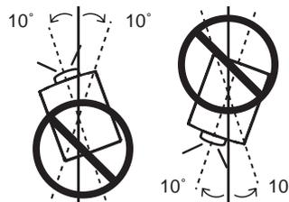
プロジェクターの水平軸を10度以上傾けて上方または、下方に投射しないでください。
