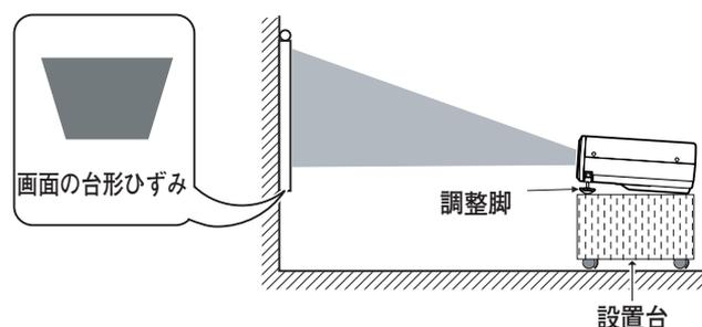
※ 画面のひずみが大きいときは、設置台を高くして調整してください。
