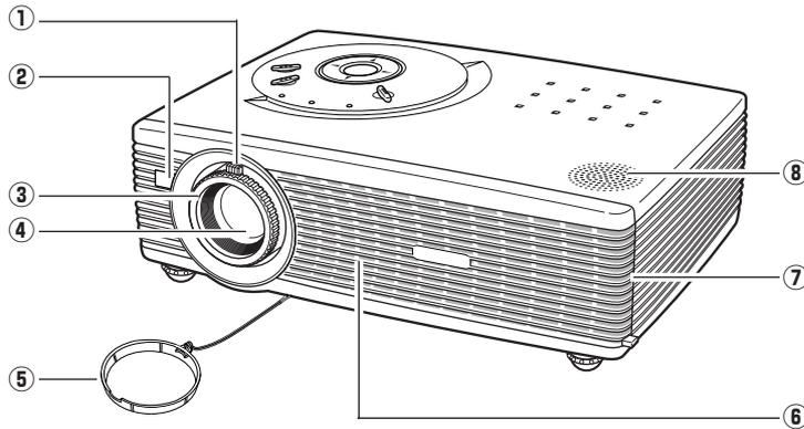
**!** ランプ点灯中はレンズキャップをかからずはすしてください。レンズキャップをつけたまま点灯すると、レンズキャップの変形および火災の原因となります。
