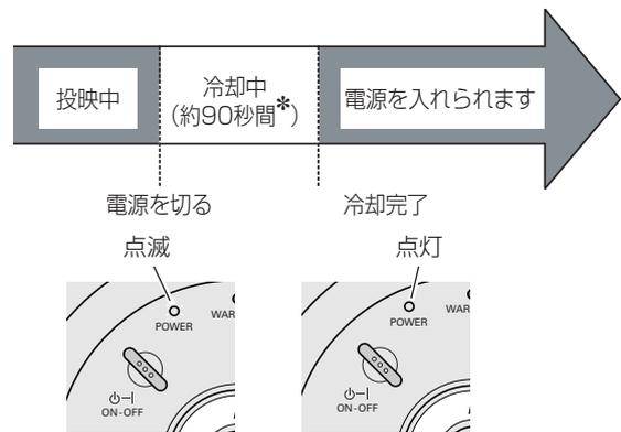
プロジェクターを24時間以上連続して使用しないでください。連続して使用する場合24時間に一度電源を切り、1時間休ませてください。続けて使用すると、ランプの寿命を縮める原因となります。
