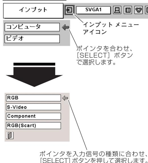
※ SCART 21ピン端子は、主にヨーロッパ地域で販売されているビデオ機器に備えられているビデオ出力端子で、この端子のRGB出力をプロジェクターで見るとは、ビデオ機器のSCART 21ピン端子とプロジェクターの [COMPUTER/S-VIDEO/COMPONENT IN] を専用のケーブルで接続します。[COMPUTER/S-VIDEO/COMPONENT IN] で再生されるRGB SCART信号は、480i、575iのRGB信号のみです。コンポジットビデオ信号は再生されません。
