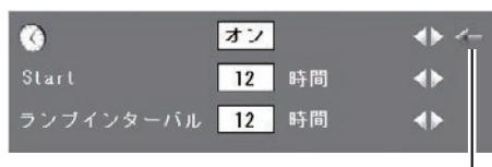
[ポイント] ボタンの左右で切り替えおよび数値の変更を行ないます。設定完了後、[SELECT] ボタンを押すと確認画面が表示されるので、「はい」を選択します。
