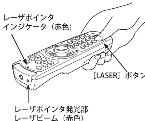
リモコンの [LASER] ボタンを押している間、レーザーポインタインジケータが赤色で点灯し、リモコンのレーザーポインタ発光部からレーザービームが出ます。(P.18 ページ)
