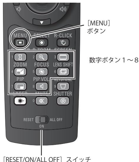
※ 設定したリモコンコードを初期化したい場合には、リモコン下方にあるスイッチを [RESET] にセットし、その後 [ON] に戻します。
