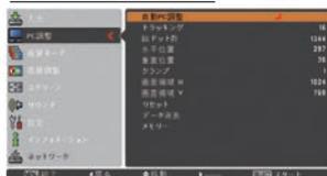
※ 自動 PC 調整機能で「トラッキング」「総ドット数」「水平位置」「垂直位置」のすべてを完全に調整できないコンピュータもあります。その場合は、マニュアルで調整し、「カスタムモード」に登録してください。
