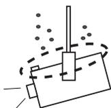
天井から吊り下げたり、高いところへ設置してご使用になるときは、吸気口や排気口、エアフィルター周辺の掃除を定期的に行なってください。吸気口や排気口にホコリがたまると、冷却効果が悪くなり、内部の温度上昇を招いて故障や火災の原因となります。吸気口や排気口についてのホコリは掃除機などで取りのぞいてください。
