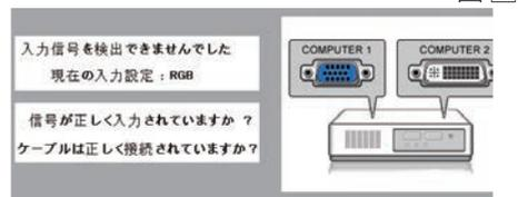
ケーブルが正しく接続されていても、映らないときは、コンピュータの外部出力設定を取扱説明書などで確認してください。また、ノートブック型は、キーボードの [Fn] キーを押しながら、ファンクションキーを押す、などの操作が必要な場合があります。
