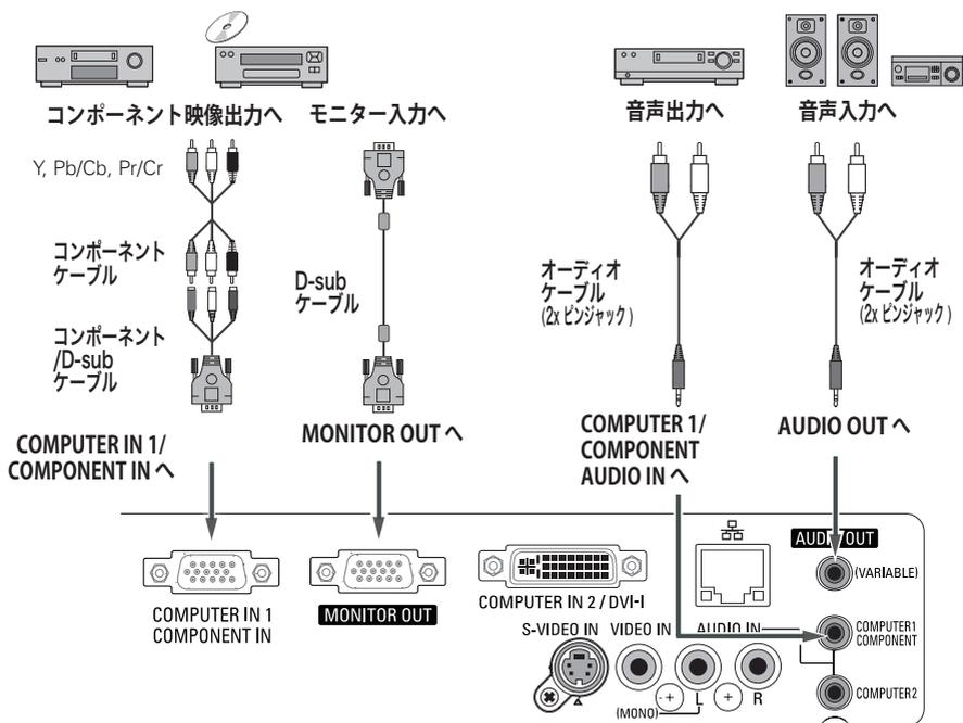
※ 内蔵スピーカからは、接続した機器の音声信号が出力されますが、[AUDIO OUT] にプラグがささっていると、内蔵スピーカから音は出ません。プロジェクター本体から音を出したいときは、[AUDIO OUT] にプラグがささっていないか、確認してください。
