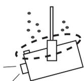
天井から吊り下げたり、高いところへ設置してご使用になるときは、吸気口や排気口、エアフィルターの掃除を定期的に行なってください。吸気口や排気口にホコリがたまると、冷却効果が悪くなり、内部の温度上昇を招いて故障や火災の原因となります。吸気口や排気口についてのホコリは掃除機などで取りのぞいてください。
