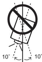
プロジェクターの水平軸を 10 度以上傾けて下方向に投射しないでください。
