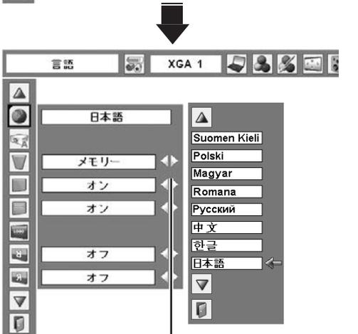
選択したい項目にポインタを合わせて [ポイント] ボタンの左右で設定します。
