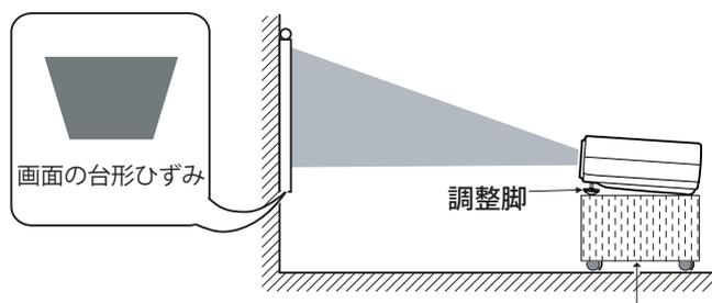
※画面のひずみが大きいときは、設置台を高くして調整してください。
