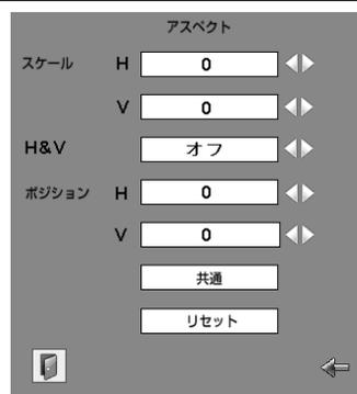
※ [ポイント] ボタンの上下で項目を移動し、[ポイント] ボタンの左右で値を調節します。
