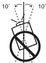
プロジェクターの水平軸を 10 度以上傾けて上方向に投射しないでください。
