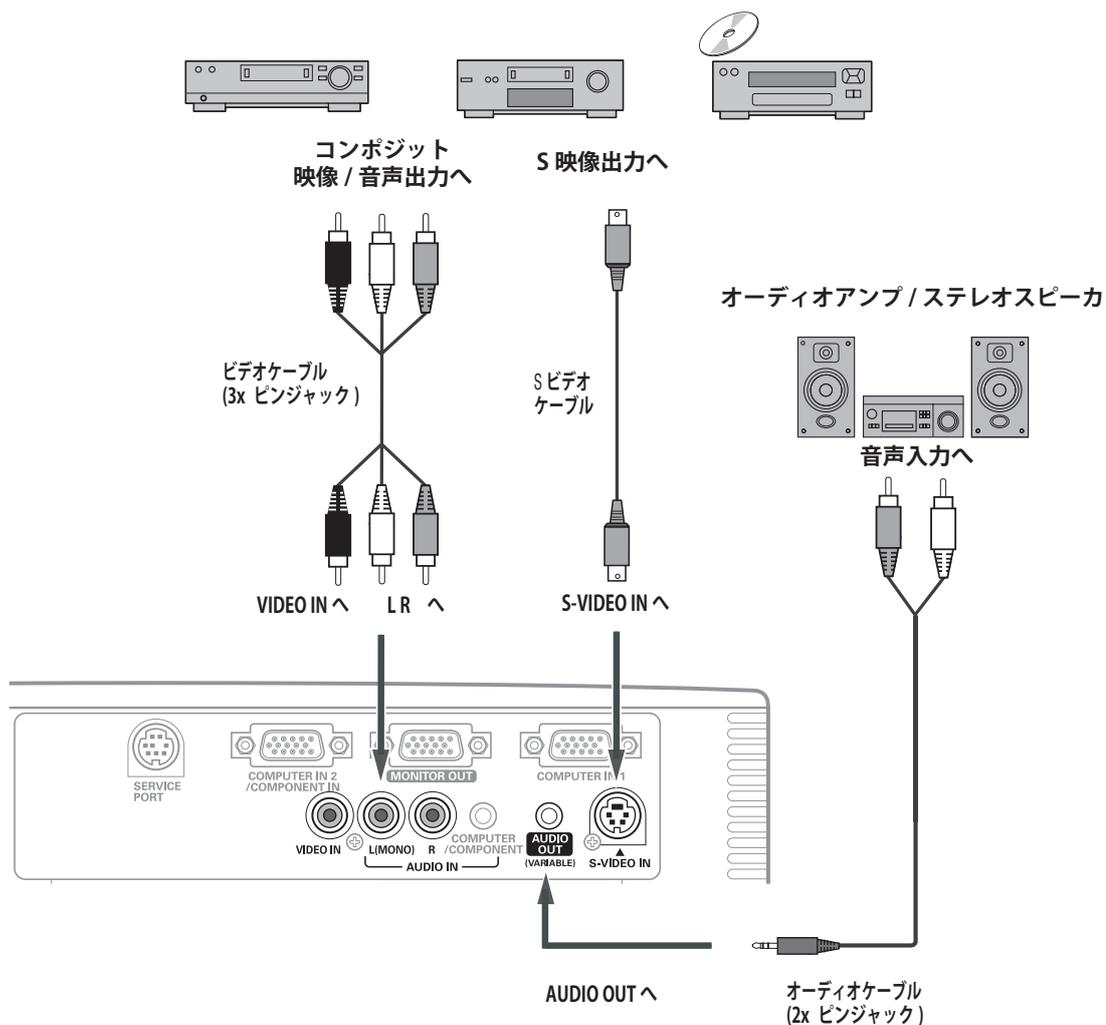
※ 2台のビデオ機器を接続しているときは、インプットメニュー内の信号選択メニューで「Auto」に設定していても、プロジェクターは入力端子へのプラグの挿入（信号の有無ではない）を検知して、(1) S-video、(2) Video の順で入力端子を自動選択します。接続されている入力端子が選択されないときは、インプットメニュー内の信号選択メニューでポインタを合わせて [SELECT] ボタンで選択してください。
