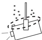
天井から吊り下げたり、高いところへ設置してご使用になるときは、吸気口や排気口、エアフィルターの掃除を定期的に行なってください。吸気口や排気口にホコリがたまると、冷却効果が悪くなり、内部の温度上昇を招いて故障や火災の原因となります。プロジェクターについてのホコリは掃除機などで取りのぞいてください。
