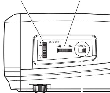
レンズシフトを合わせたら、[レンズシフトロック]で固定します。（レバーを右に移動させます）
