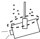
天井から吊り下げたり、高いところへ設置してご使用になるときは、吸気口や排気口、エアフィルター周辺の掃除を定期的に行ってください。吸気口や排気口にホコリがたまると、冷却効果が悪くなり、内部の温度上昇を招いて故障や火災の原因となります。吸気口や排気口についたホコリは掃除機などで取りのぞいてください。
