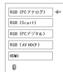
\*SCART 21 ピン端子は、主にヨーロッパ地域で販売されているビデオ機器に備えられているビデオ出力端子で、この端子の RGB 出力をプロジェクターで見るには、ビデオ機器の SCART 21 ピン端子とプロジェクターの [ANALOG] を専用のケーブルで接続します。[ANALOG] で再生される RGB SCART 信号は、480i、575i の RGB 信号のみです。コンポジットビデオ信号は再生されません。
