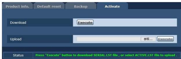
1. 「Upload」項目の [参照] をクリックし入手した「ACTIVE.LST」が保存されているフォルダーを指定する
