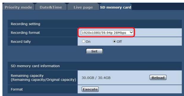
1. 「Recording format」項目でサイズ、フレームレート、ビットレートをプルダウンリストから選択する
