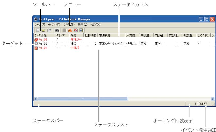
\*ターゲット行をダブルクリックすると Web ブラウザが起動し、ターゲットのログインウィンドウが表示されます。(※p.31)
