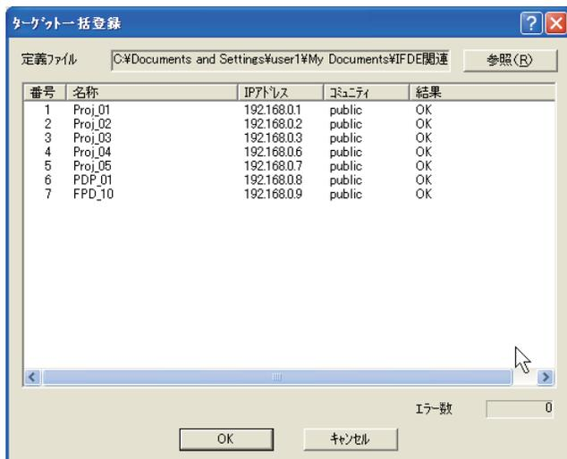
\* 取り込んだ定義ファイル中にエラーがある場合には「結果」カラムにエラー情報が表示されます。定義ファイルを再編集して再度取り込みを行います。
