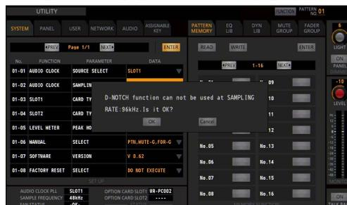
[OK] をタッチするとSAMPLING RATEは96 kHzに変更され、ダイナミックノッチ機能が使用できなくなります。[Cancel] をタッチするとSAMPLING RATEの切り替えが行われず、48 kHzのままになります。
