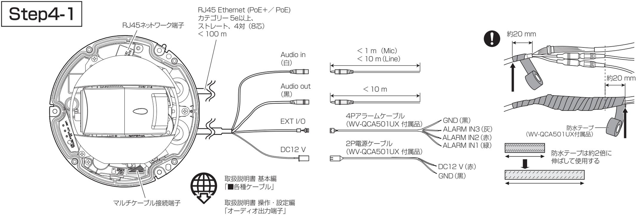
■ RJ45 Ethernetケーブル（現地調達）を直接カメラに接続する場合
