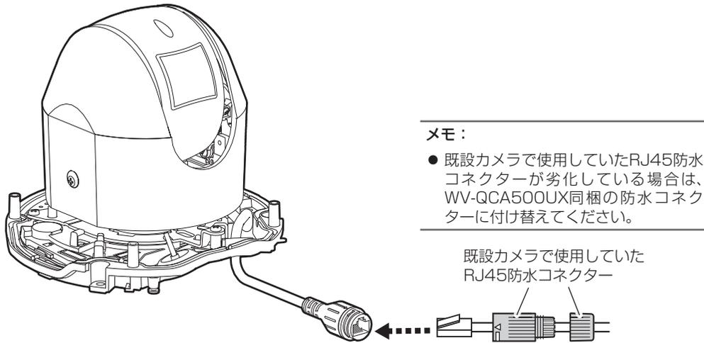
RJ45 防水コネクタ（付属品）の組み立て方法
