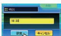
本プロジェクターは内蔵電池を使用していません。プロジェクターの電源を切った場合（スタンバイモードが "エコ" (☞p.72) の場合)、ネットワークの再設定を行った場合、あるいは「有線 LAN」「無線 LAN」入力の切り換えを行った場合、日付・時刻情報は失われます。タイマー機能を使用している場合では、正常に時刻設定されるまで利用タイマー機能は使用できません。時刻設定に NTP アドレスを使用している場合は、プロジェクト起動時に現在時刻の取得を行い、正常に取得完了するとタイマー機能が利用可能になります。
