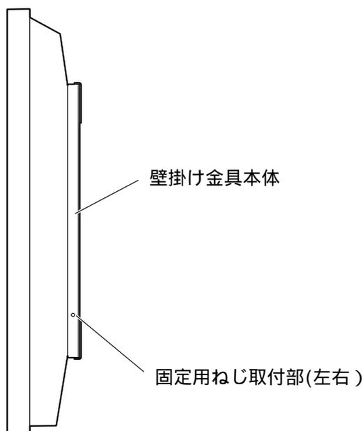
仮止めした左右の固定用ねじを締め付けます。
