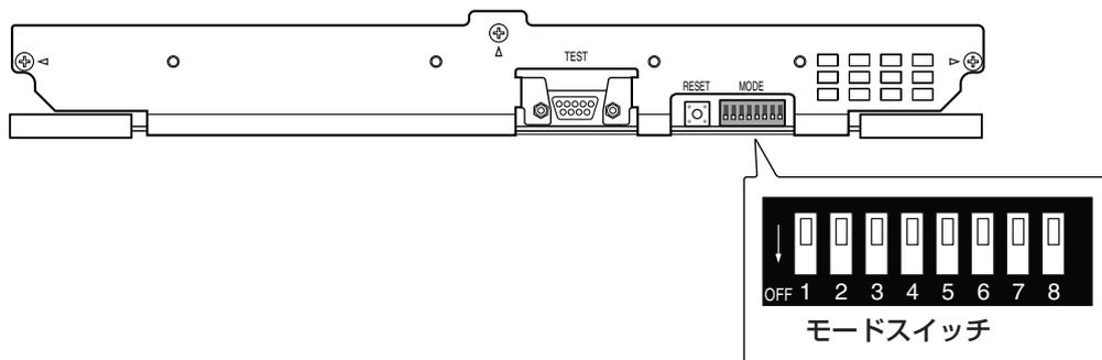
ビデオ出力ボード1/ビデオ出力ボード2の識別のため、前面のモードスイッチ (SW4004) と基板上のスライドスイッチ (SW1、SW2、SW3、SW4、SW4006) を以下のように切り替えてください。
