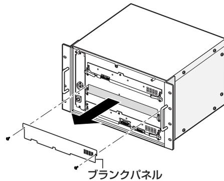
5 カードブラアングルにボードのカードブラを掛けて押し込み、取付ねじで固定し、前面パネルを取り付けます。
