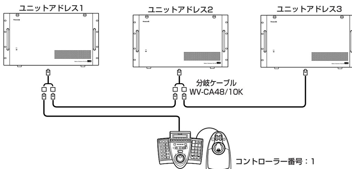
本機を複数台（各ユニット）操作するときは、操作するユニットを選択してから行います。ユニットの選択は、[テンキー] でユニットアドレスを入力し、[SHIFT] ボタンを押しながら [ユニット] ボタンを押すことによって実行できます。
