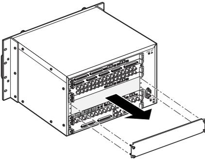
2 後面基板を挿入し、取付ねじで固定します。
