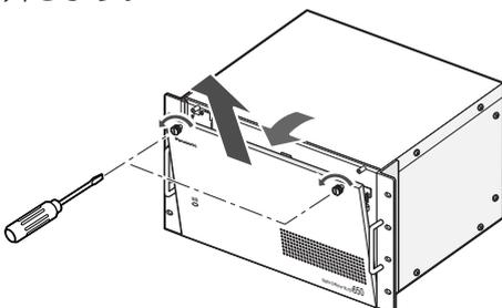
4 本機前面のブランクパネルを取り外します。
