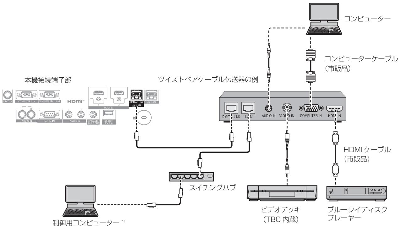
\*1 制御対象は本機、またはツイストペアケーブル伝送器になります。ツイストペアケーブル伝送器によっては制御そのものができないことがありますので、接続する機器の取扱説明書をご確認ください。
